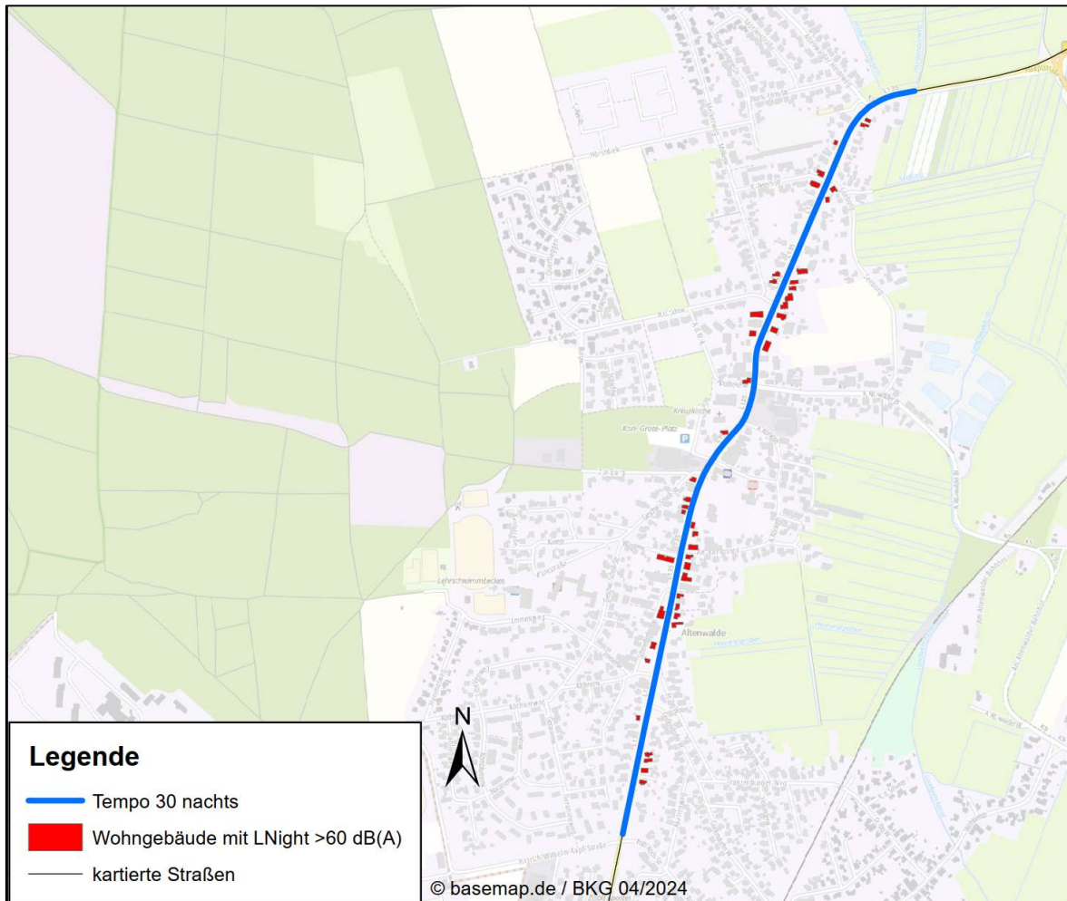
Abbildung 8: Maßnahmen an der L135 Altenwald, Quelle: Darstellung LÄRMKONTOR GmbH
