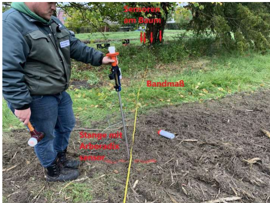
Abb.: 4-8 9 Durchführung der Messung: Das Bandmaß wird auf der Linie aus der Stammmitte über den Sensor nach außen gelegt. Die Position des Messpunktes wird in der Software eingegeben
